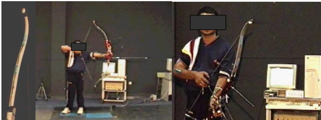
Fig. 1. “Cadena de medida” y detalle del arco instrumentado.
